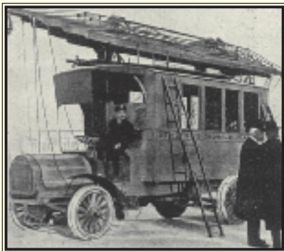
El carro automóvil radio-telegráfico era capaz de enviar radio-telegramas a una distancia de 150 kilómetros.
